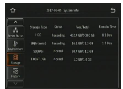
Opslagcapaciteit SD-kaart in brandwerende kast Afbeelding 230
